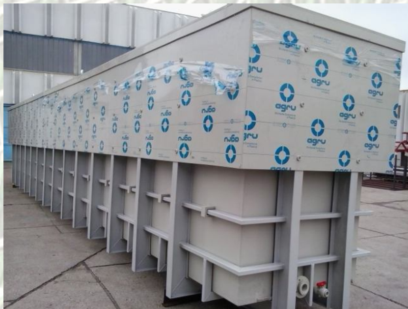
13 x 1.5 x 2 m-es kád, műanyag borítású acél merevítéssel
