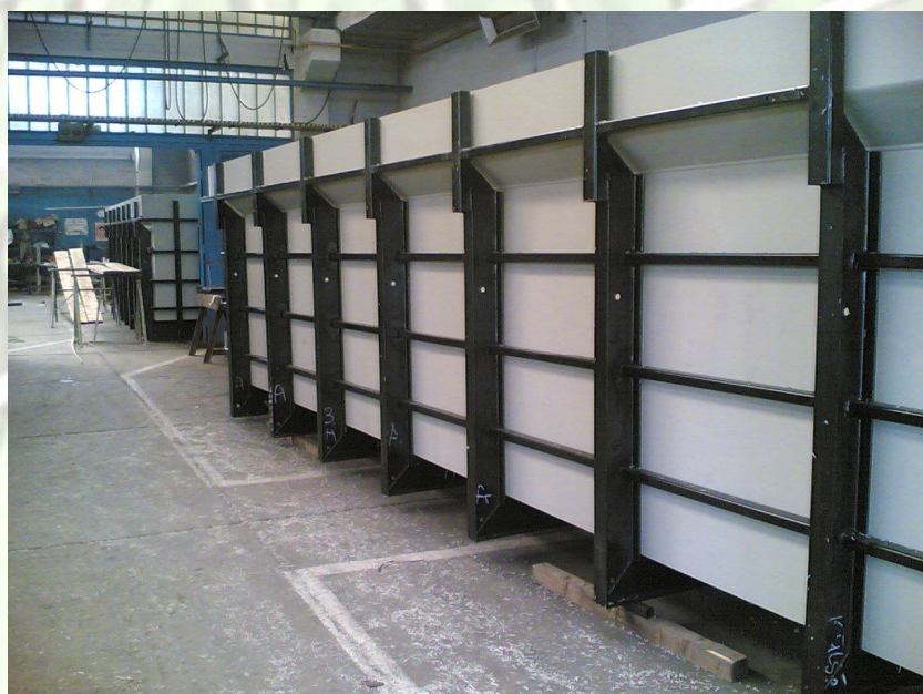
Kád előszerelése, az acél merevítés a műanyag borításra vár
